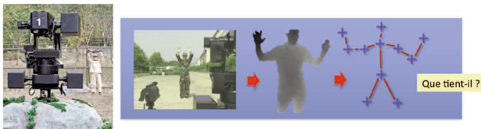
FIGURE 5 : Samsung Techwin Co SGR-AI capable d'analyser une menace et d'engagement automatique, dans le no man's land séparant la Corée du Nord et la Corée du Sud
