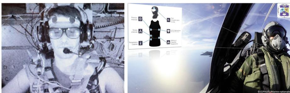
FIGURE 3 : Exemple de recueil de données électrophysiologiques dans la centrifugeuse de l'IRBA et en vol réel. À gauche, sujet portant un dispositif de *monitoring* EEG avec des électrodes sèches (Conscious Lab), et des lunettes d'*eye tracking* (Tobii Eye Tracker Glasses) et à droite un pilote portant un gilet connecté Astroskin (Projet SPEEN, AID, Marine nationale).
